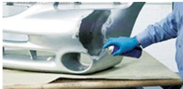
图 4 所示为粘结剂涂好之后，用刮板延展器抹平，使其光滑、平整，待固化后再作后处理。
