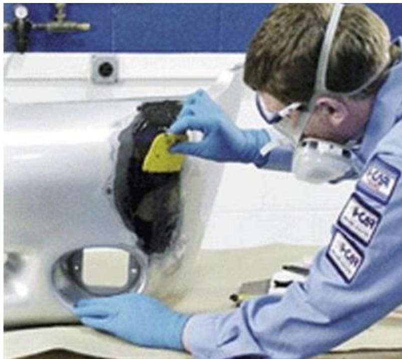
如图 6 所示，在维修用的玻纤网状织物上涂抹粘结剂后，将其粘贴到需要维修部位的后部，将二者粘接在一起，直到粘结剂完全固化。
